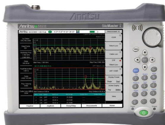
Анализатор АФУ Site Master™ S331E с сенсорным экраном 8,4" с хорошей видимостью при дневном свете, компактный размер: 273 x 199 x 91 мм, небольшой вес: 2,71 кг
